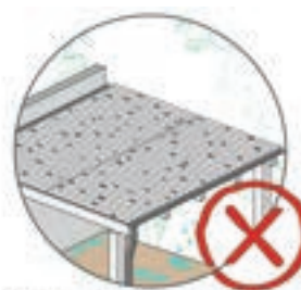
Telhado com telhas esburacadas e rachadas favorecendo goteiras e infiltrações
