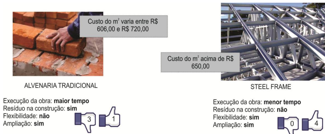
Figura 5 - Comparativo entre os sistemas construtivos em alvenaria convencional e em Steel Frame
